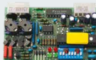
Induktionsslingedetektor Instickskort 1- eller 2-kanaler, lämplig för 2 separata induktionsslingor, levereras utan slingkabel.
