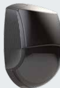
3D laserscanner scanprotect Övervakning av området med sju snedställda laserstrålar enligt ljusmätningens principen, individuella utvärderingsmöjligheter, i första hand för ytterområden, skyddsklass för kåpan IP 65.
