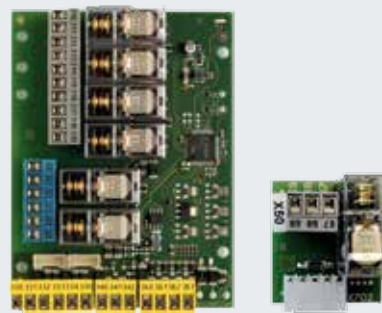
Expansionskretskort för styrsystemen: BK 150 FU E-1 (E FU H) AK 500 FUE-1 (E FU H)
